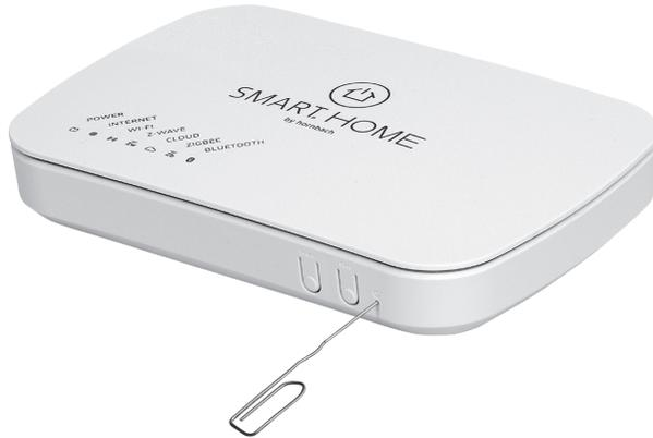
Setzen Sie das Gateway vor der Weitergabe an Dritte zurück, um alle Daten zu entfernen. Um das Gerät zurücksetzen, führen Sie bitte einen Stift in die Reset-Öffnung an der Vorderseite des Gateways ein und halten Sie den dahinter liegenden Knopf für 10 Sekunden gedrückt. Beim Zurücksetzen des Gateways ist eine unterbrechungsfreie Stromversorgung sicherzustellen.
