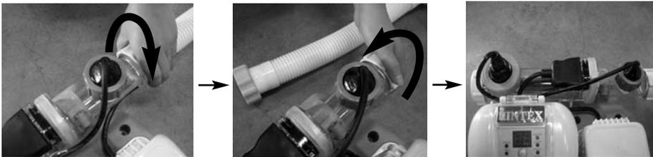
4. Schrauben Sie die Muffe im Uhrzeigersinn von der Kupferelektrode (5) ab und entfernen Sie sie von der elektrolytischen Zelle (4). Heben Sie die Kupferelektrode auf.
