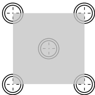
Die Stelzlager werden sowohl an allen vier Ecken als auch in der Mitte der Platte positioniert, so wie in der Skizze zu sehen ist.
