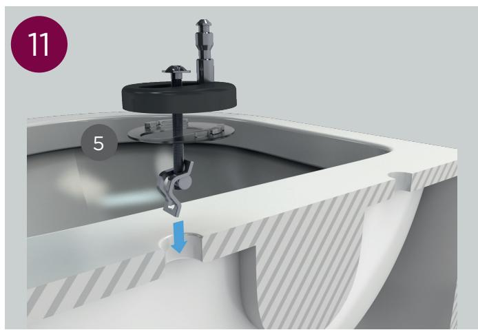
DE / Schieben Sie die vormontierte Halterung zusammen mit der Unterlagscheibe (Nr.5) mit abgeklapptem Dübel in die Öffnung im WC.
