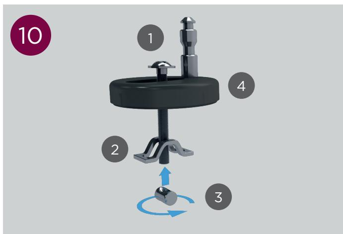
DE / Setzen Sie die Schraube (Nr.1) von oben in die Montageplatte (Nr.4) ein. Dann schieben Sie den Kippdübel (Nr.2) von unten wie abgebildet auf die Schraube und drehen dann die Kontermutter (Nr.3) auf die Schraube.
