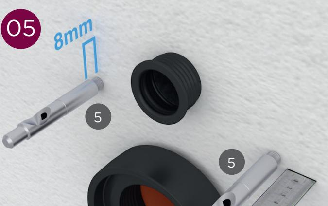
DE / Die Bolzen (5) werden auf die vorhandenen Gewindestangen geschraubt. Beachten Sie den Abstand von 8 mm zur Wand (12 mm bei Verwendung eines Schallschutzes).
