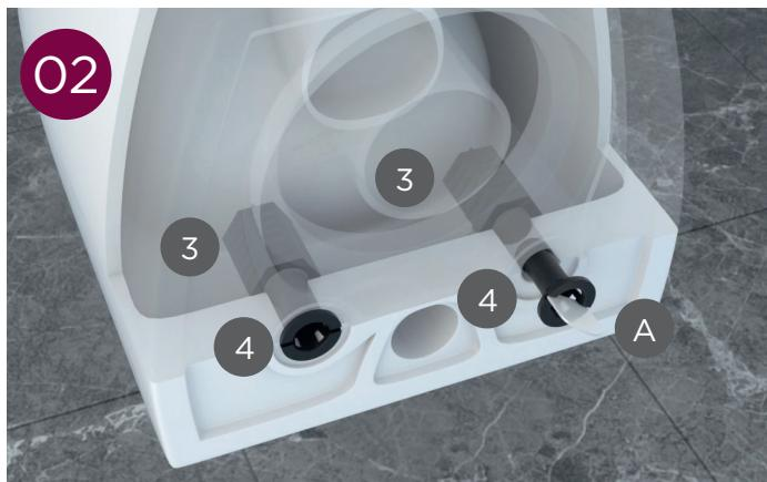
**DE /** Legen Sie die Toilette auf die Oberseite. Schieben Sie die Montagestücke (3) in die Befestigungslöcher der Toilette. Verschrauben Sie nun die Endstücke (4) mit dem Montageschlüssel (A) von außen auf die Montagestücke (3). Die Madenschraube mit dem Trichter muss dabei in Richtung der Öffnungen für den WC-Sitz zeigen.
