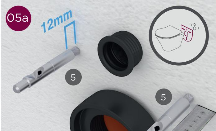
SE / Bultarna (5) skruvas fast på de gängade stavarna. Beakta ett avstånd av 8 mm till väggen (12 mm vid användning av ett ljudskydd).
