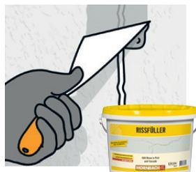
**Wichtig:** Die Fassade muss sauber und trocken sein. Der HORN-BACH Rissfüller kann dann nach Anweisung aufgetragen werden und sollte ausreichend trocknen. Anschließend kann der Anstrich mit HORN-BACH Fassadenfarben erfolgen.
