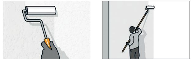
Anschließend mit einem Farbroller die Fassadenfarbe unverdünnt erst von oben nach unten, dann im Kreuzgang quer darüber aufstreichen. Zusammenhängende Flächen immer nass in nass streichen, um ein optimales Anstrichergebnis zu erzielen.
