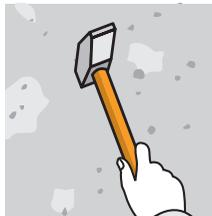
**Kratzttest:** Überprüfe die Haftung des Altanstrichs, indem Du einen Spachtel über die Fassade und den Sockel ziehst und auf Ablösungen achtest. Bei starkem Abrieb der Beschichtung sollte der nicht fest haftende Anstrich entfernt werden. Bei schwachem Abrieb empfiehlt sich eine Grundierung passend zum Endanstrich.
