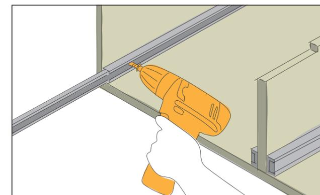
Verschraube die Schubladenschiennen so, dass diese im eingeschobenen Zustand vorne bündig sind. Es werden die 4x16 mm Schrauben benötigt. Die Schraubenlöcher müssen nicht vorgebohrt werden.
