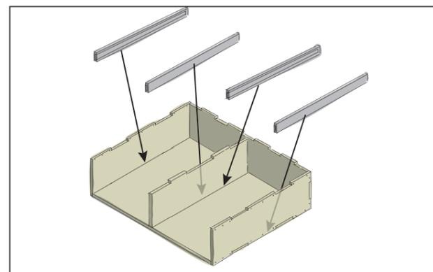
In beide Schubladenfächer kommen jeweils zwei Schubladenschiennen. Die Schienen haben eine Breite von 19 mm. Bringe diese am besten unten am Boden des Korpus an. Hier sind diese am leichtesten zu montieren.
