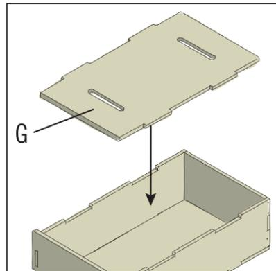
Die Abdeckung (G) wird nur lose aufgelegt. Sie kann zum Befüllen der Schublade leicht abgenommen werden.
