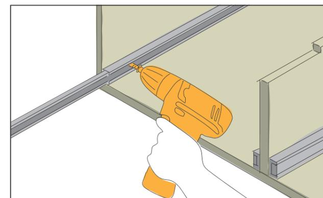
Verschraube die Schubladenschiennen so, dass diese im eingeschobenen Zustand vorne bündig sind. Es werden 4x16 mm Schrauben benötigt. Die Schraubenlöcher müssen nicht vorgebohrt werden.
