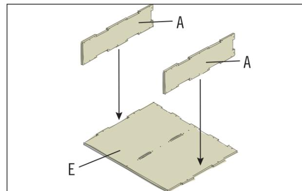
Zur Verschraubung der gesamten Holzkonstruktion des Schubladengehäuses werden 3,5x35 mm Schrauben verwendet. Die beiden Seitenwände (A) an den Aussparungen der Grundplatte (E) einsetzen und die Seitenwände von unten durch die Grundplatte an den vorhandenen Bohrlöchern verschrauben. Zusätzlich werden die Seitenwände von außen an der Grundplatte angeschraubt.
