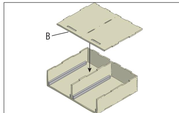
Nach dem Einbau der Schubladenschiennen kann die Gehäuseabdeckung (B) aufgelegt und mit 3,5x35 mm Schrauben an der Zwischenwand, den Seitenwänden und der Rückwand verschraubt werden.
