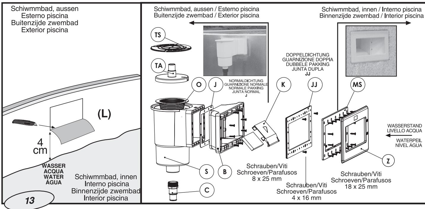
**DE BEFESTIGUNG DES SKIMMERKÖRPER AM SCHWIMMBAD:** (Folgen Sie den Anweisungen für den Skimmer Ihrer Reinigungsanlage). Verbinden Sie das Skimmermundstück **B** mit dem Skimmerkörper **S** und legen Sie eine Normaldichtung **J** dazwischen.
