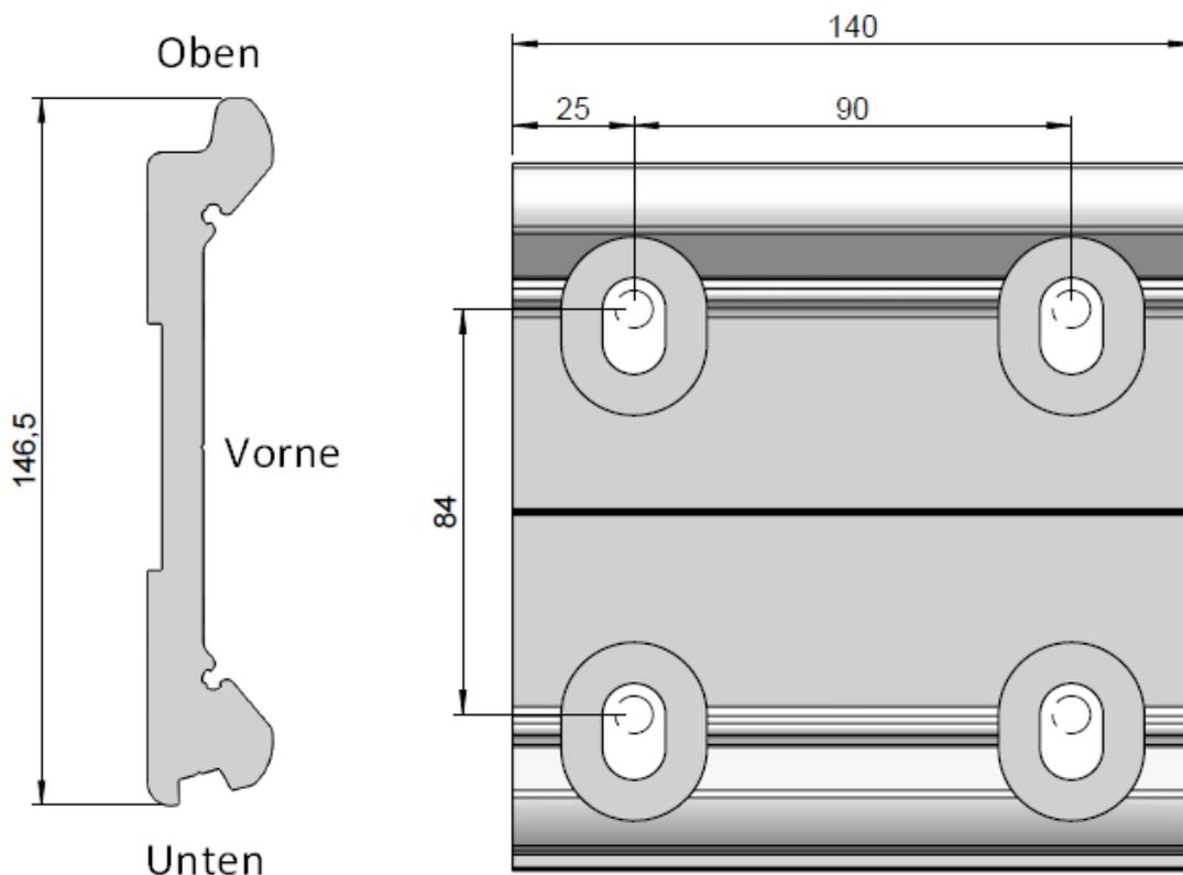
Haken bzw. schieben Sie die Montageträger in die Anlage ein und verschrauben Sie diese an der Unterseite mit den mitgelieferten Kreuzschlitzschrauben. Die Montageträger müssen mit den Befestigungspunkten der Konsolen übereinstimmen. (eventuell muss eine Korrektur vorgenommen werden)
