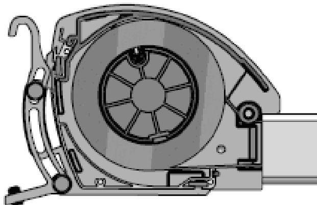
Hängen Sie die Anlage nun mit mindestens zwei Personen in die Konsolen ein und sichern Sie diese mit den Stiftschrauben 10 x 16. Ziehen Sie das Ausfallprofil etwas heraus und öffnen Sie das Profil, sodass Sie die Schnur sehen können (siehe Pfeil). Legen Sie den Deckel zur Seite, da dieser erst zum Abschluss der Montage wieder aufgesteckt wird. Führen Sie die Schnur über die Rolle der Führungsblöcke im Ausfallprofil ein.
