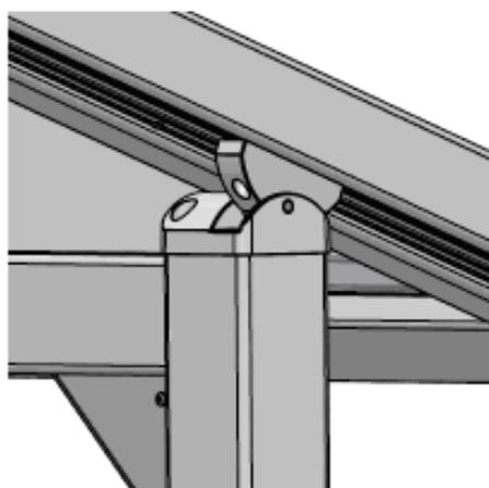
Verbinden Sie die Führungsschiene mit dem Standpfosten. Die Schrauben nur leicht anziehen, da die Konstruktion noch ausgerichtet werden muss.
