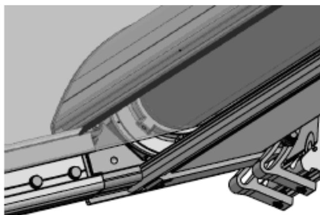
Im nächsten Schritt schieben Sie die Führungsschienen in den Kasten/ das Profil ein. Eine zweite Person hebt die Führungsschiene an und der Pfosten/ Standfuß wird unter das Profil gestellt. Der Standfuß/ Pfosten wird im vorderen Bereich der Führungsschiene, bis ca. 1 m nach hinten, montiert.
