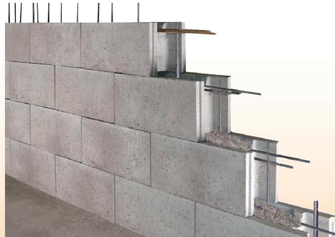
Beton-Schalungssteine sind Formteile, in welche die Betonmasse eingefüllt wird. Zusätzliche Schalarbeit entfällt. Lediglich bei Eckverbindungen und Wandanschlüssen muss beim Einfüllen des Betons verschalt werden.
