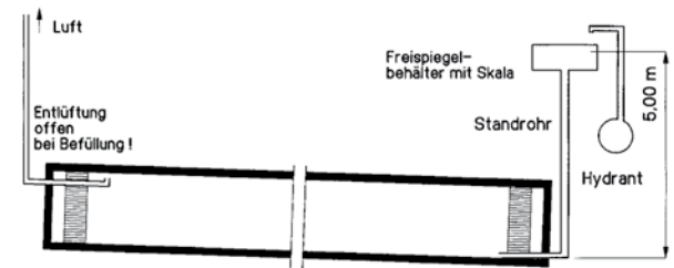
Bild 10 Prüfung auf Wasserdichtheit
