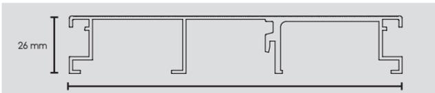
Aufbauhöhe inkl. Montageklammer und Unterlegplatte max. 31 mm
