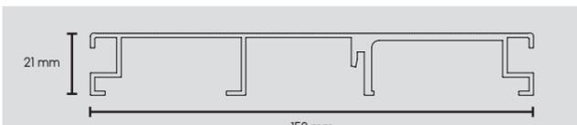
Aufbauhöhe inkl. Montageklammer und Unterlegplatte max. 26 mm
