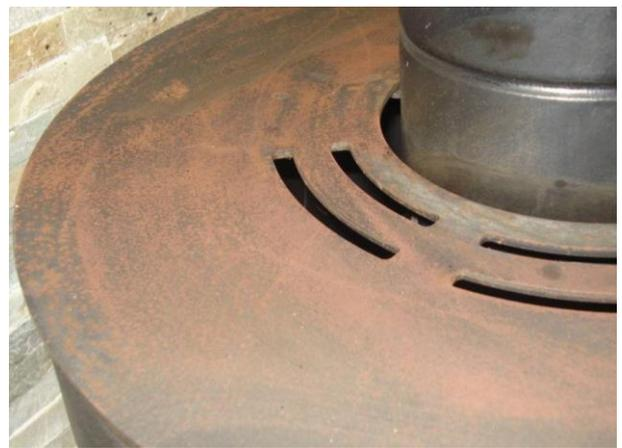
*Lackschäden verursacht durch Reinigung mit einem feuchten Lappen und Reinigungsmittel. Deutliche abwischspuren.*
