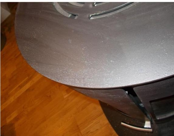
*Lackschäden verursacht durch Reinigung mit einem feuchten Lappen. Deutliche abwischspuren.*
