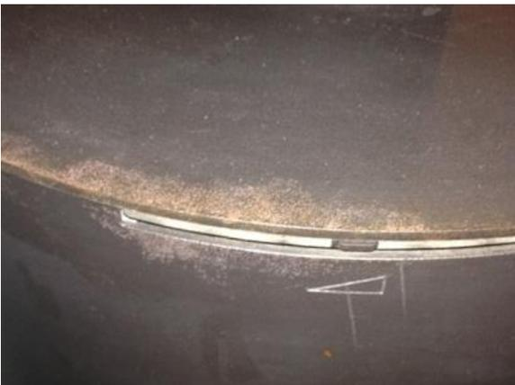
*Lackschäden verursacht durch Reinigung mit einem feuchten Lappen. Deutliche abwischspuren.*
