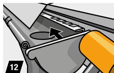
Das Rinnenendstück wird am Rinnenende durch manuelles Drücken oder mit Hilfe eines Gummihammers (Abb. 12) angebracht. Es wird ohne Silikon befestigt.
