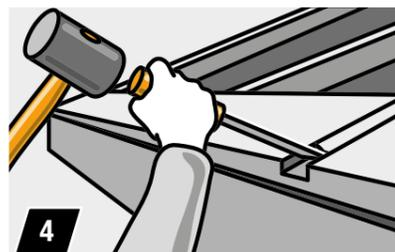
Schlitze ausstemmen (Abb. 4), damit die Eisen bündig in die Sparren eingelassen werden können. Vor der Befestigung müssen die langen Rinnenhalter abgebogen werden. Das Abbiegen geht am einfachsten mit einer großen Kneifzange oder im Schraubstock.
